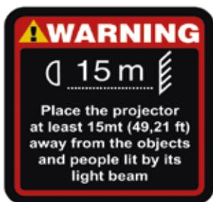
*Le indicazioni del costruttore, riportate con un pittogramma nel manuale e anche sullo stesso apparecchio, su un faro a testa mobile con lampada a scarica da 400 W.*
