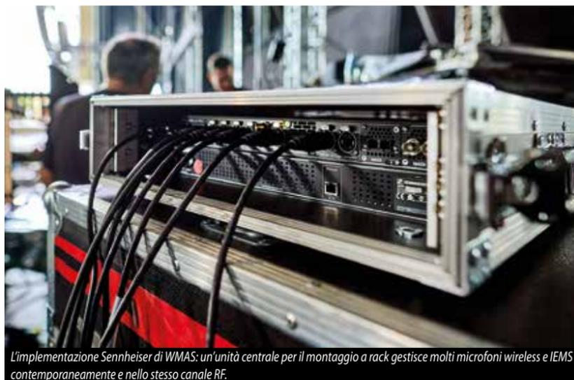
L'implementazione Sennheiser di WMAS: un'unità centrale per il montaggio a rack gestisce molti microfoni wireless e IEM contemporaneamente e nello stesso canale RF.
