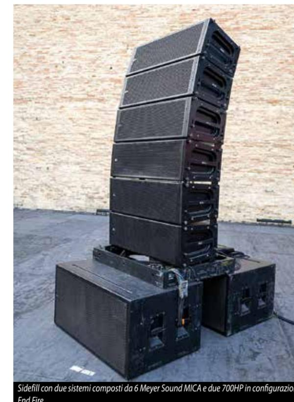
Sidefill con due sistemi composti da 6 Meyer Sound MICA e due 700HP in configurazione End Fire.
