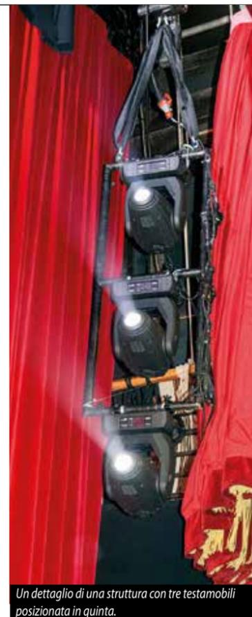
Un dettaglio di una struttura con tre testabili posizionata in quinta.
