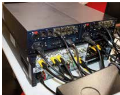
Il retro del C-Mini con le connector card estraibili.
