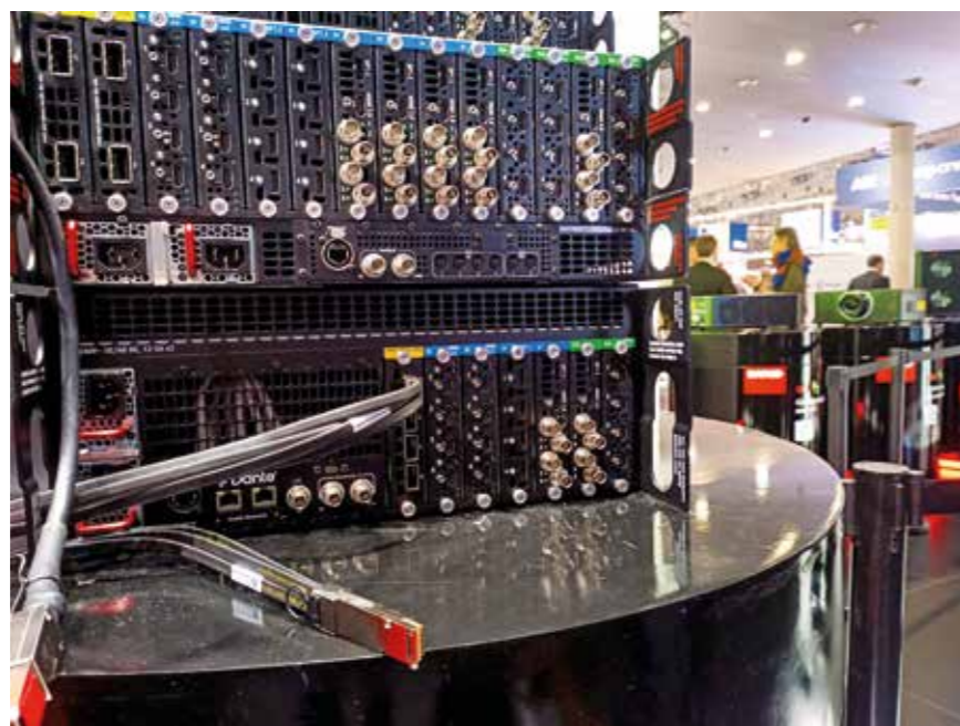
Il retro di Encore3, le schede di input e di output sono intercambiabili per ottenere la configurazione desiderata, il cavo High Speed Link in primo piano serve per connettere tra loro più macchine ed espandere così il numero di pixel e di uscite che è possibile gestire.
