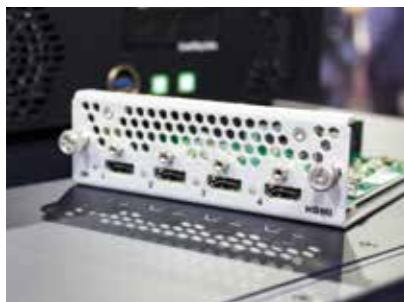
Connector card con 4 uscite HDMI.
