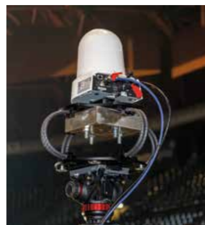
Il rimedio artigianale per isolare la telecamera dalle vibrazioni.
