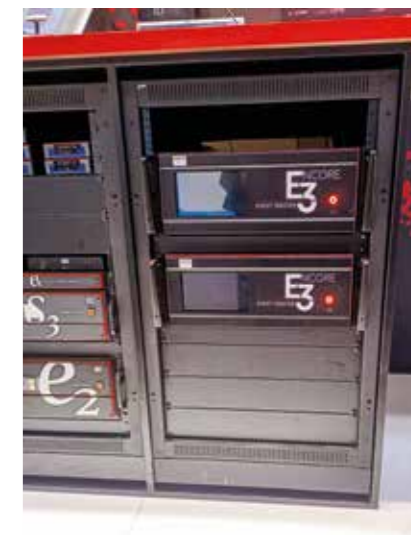
Il presentation switcher Encore3, recentemente introdotto da Barco, può essere considerato una delle teste di serie di questi sistemi.
