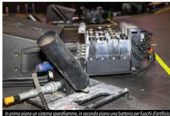
In primo piano un sistema sparafiamme, in secondo piano una batteria per fuochi d'artificio.
