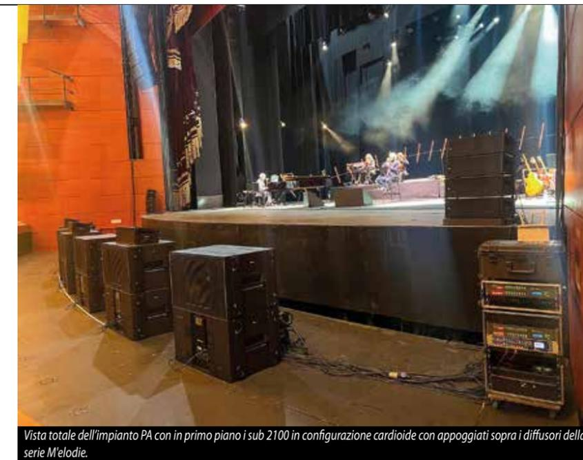
Vista totale dell'impianto PA con in primo piano i sub 2100 in configurazione cardioide con appoggiati sopra i diffusori della serie M'elodie.
