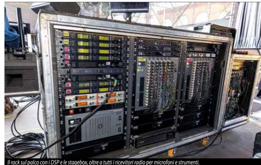
Il rack sul palco con i DSP e le stagebox, oltre a tutti i ricevitori radio per microfoni e strumenti.
