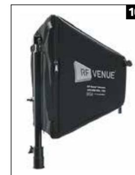
bile di 50 W. Il connettore di ingresso, diversamente da quelle viste in precedenza, è un connettore "N", spesso utilizzato nel broadcasting professionale. La caratteristica principale di questa antenna è che, essendo corta, ha un lobo di radiazione molto largo su entrambi i piani, ciò consente di coprire palchi molto grandi, anche con passerelle (sperimentato di persona!).
