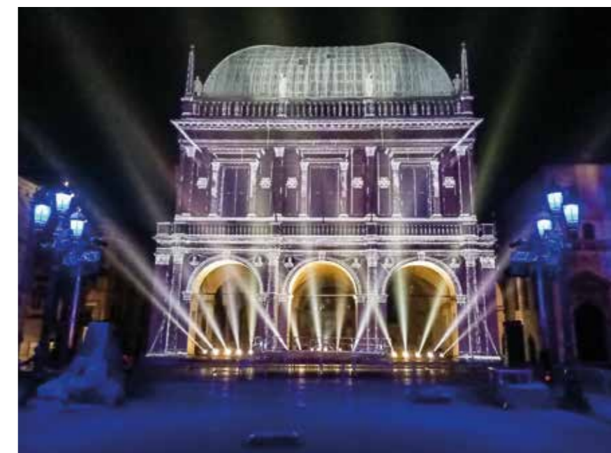
Tramite i media server è possibile calibrare pixel-to-pixel la geometria di un'immagine proiettata per far sì che aderisca perfettamente agli elementi architettonici di un edificio. Nella foto il Palazzo della Loggia di Brescia, capitale italiana della cultura 2023.
