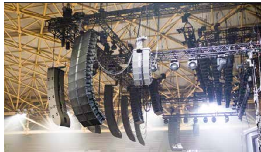
I due cluster per la copertura delle tribune laterali formate da 12 K2 più un cluster di 6 Kara.
