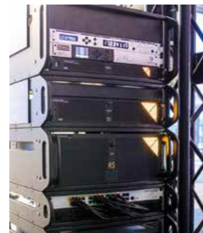
Nella foto Pixera One, Pixera Two e Pixera Four, tre modelli di server con caratteristiche diverse per i vari usi: installazioni, live show e video-mapping, studi XR.
