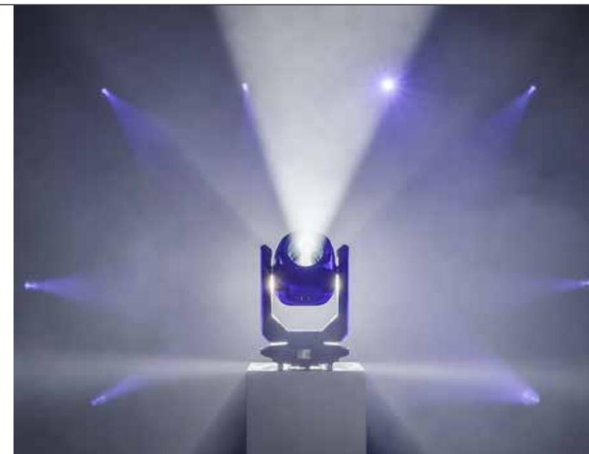
Il proiettore è dotato di due filtri frost nello spazio tra le ottiche, uno leggero e uno più diffuso, entrambi inseribili in modo progressivo e anche combinabili per un effetto molto diffuso. Si può scegliere, inoltre, tra due prismi: uno radiale a 5-facce e uno lineare a 6-facce. Entrambi sono rotanti e con posizione indicizzabile attraverso una gamma di 540°.
