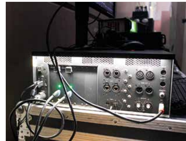
Il media server Disguise è dotato di vari slot in cui possono essere inserite delle schede di input e di output con connessioni e standard diversi, creando configurazioni complesse. In questo caso monta una semplice scheda con due output HDMI. Disguise è stato il primo media server a installare sui suoi hardware connessioni audio professionali sia input che output con connettore XLR stereo.
