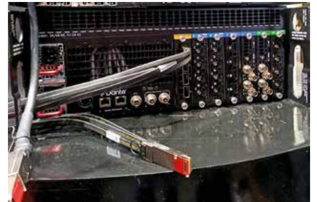
Il nuovo image processor Barco ENCORE3 è dotato di due connessioni RJ45 per accedere al network DANTE, permettendo di incorporare l'audio nel flusso multimediale.
