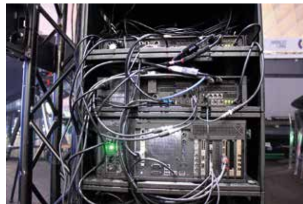
Il media server PIXERA four QUAD con 4 uscite DisplayPort e, sulla destra, 4 uscite mini-DisplayPort.
