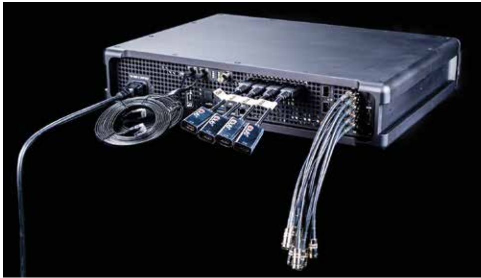
Il nuovo Watchpax 64 della svedese Dataton, oltre alle 4 uscite DisplayPort, implementa su 8 connessioni mini-BNC bidirezionali, configurabili indipendentemente come input o come output, 8 porte 3G-SDI oppure 2x12G-SDI o 1x12G-SDI e 4x3G-SDI.
