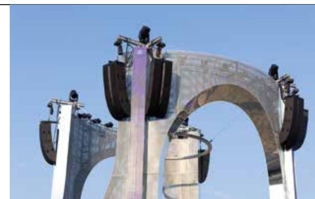
Il dettaglio del PA a 360° composto da diffusori L-Acoustics L2+L2D.
