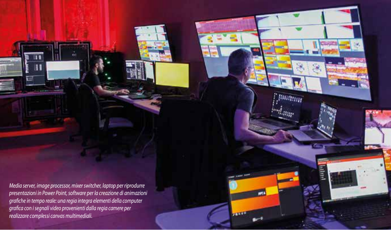
Un moderno Image Processor per la gestione dei flussi visivi in un evento dal vivo. La prima cosa che si nota nelle schede di input e di output di queste macchine è la compresenza di connettori di natura diversa, alcuni pertinenti all'ambito video (SDI), altri tipici dei sistemi informatici (HDMI, Display Port).
