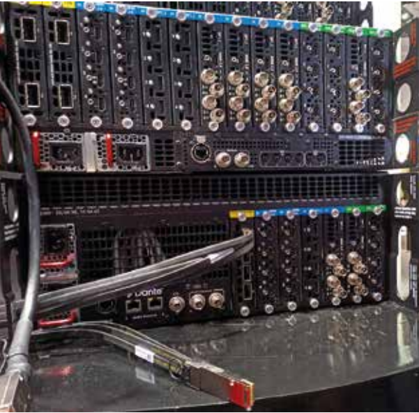
Un moderno Image Processor per la gestione dei flussi visivi in un evento dal vivo. La prima cosa che si nota nelle schede di input e di output di queste macchine è la compresenza di connettori di natura diversa, alcuni pertinenti all'ambito video (SDI), altri tipici dei sistemi informatici (HDMI, Display Port).
