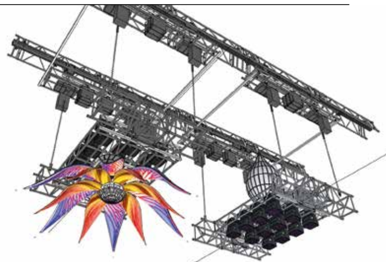
Il disegno dei pods: si muovono, salgono, scendono, possono viaggiare sospesi e possono ruotare di 180°. Qui sono posizionati i fiori in movimento.
