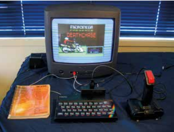
Il mondo dei videogiochi ha creato i codici che hanno permesso lo sviluppo della computer grafica. Lo ZX Spectrum prodotto dalla Sinclair dal 1982 al 1985 non aveva una vera e propria GPU, il suo unico chip operava costantemente in modalità grafica con risoluzione di 256 x 192 pixel. Utilizzando 8 colori di base ne poteva generare fino a 15 e il collegamento al televisore avveniva con un cavo RF, sintonizzando il televisore sul canale UHF 36.
