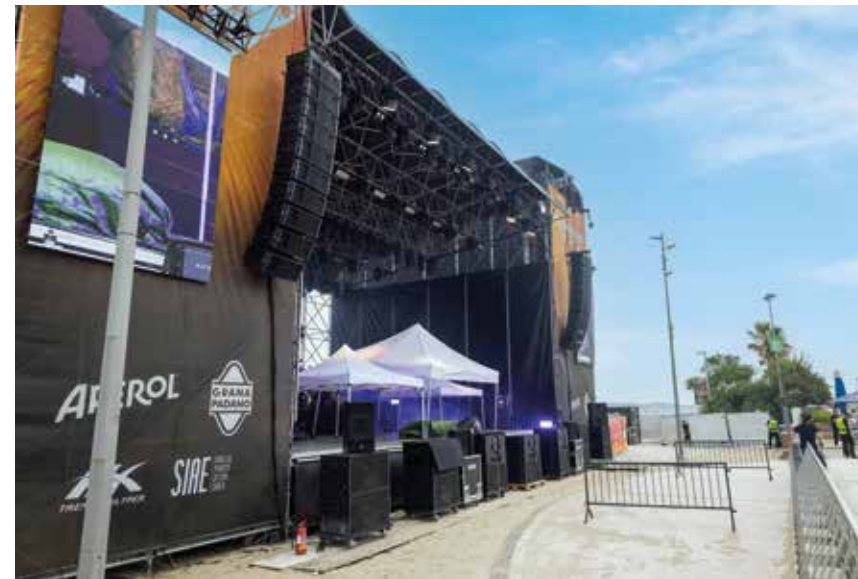
Vista dell'impianto Meyer Sound Panther sospeso, con a terra i front fill 2100-LFC.
