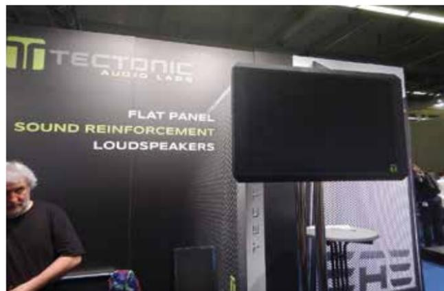
Il diffusore Tectonic PL-11, contenente un solo altoparlante planare da 200 W: fino a 118 dB da 100 Hz a 20 kHz.
