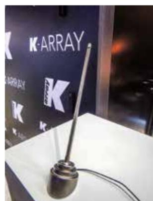
Il microfono Capture-KMC20, di K-Array, con tecnologia PAT, composta da otto capsule da 4 mm in una configurazione line array.
