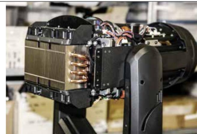
Tecnologia WTE (*White Transferable Engine*), il nuovo brevetto ROBE che permette la rapida intercambiabilità della sorgente LED.
