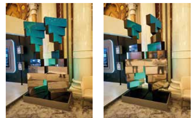
Schermo LED dinamico. La rotazione è sincronizzata con il contenuto multimediale.
