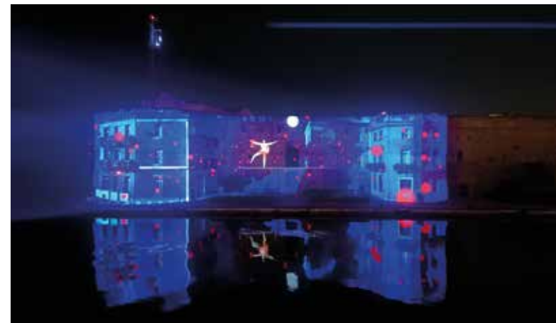
Il controllo della geometria permette di far aderire con precisione un'immagine proiettata a un oggetto tridimensionale. Nel video-mapping si sfrutta questa caratteristica per illuminare le facciate degli edifici con narrazioni visive imponenti e spettacolari. Nella foto il Castello Aragonese di Taranto durante il Medimex 2025.
