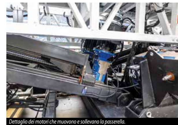
Dettaglio dei motori che muovono e sollevano la passerella.
