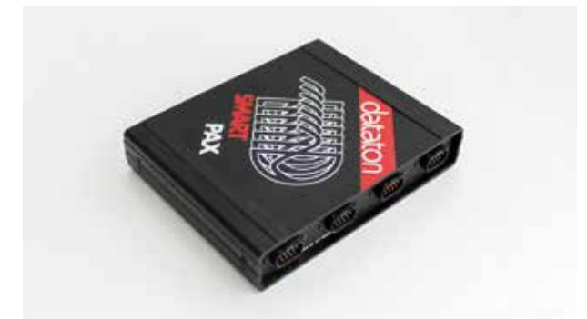
Il retro dello SmartPax. Utilizzando le quattro porte seriali e specifici cavi di connessione chiamati SmartLink si potevano pilotare, oltre alle diapositive, lettori audio, laser disc, effetti e molti altri apparati AV.
