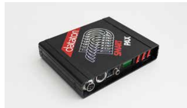
La centralina SmartPax, prodotta da Dataton alla fine degli anni Ottanta, permetteva di sincronizzare fino a quattro proiettori per diapositive. 64 centraline potevano essere collegate a catena per gestire fino ad un massimo di 256 proiettori.
