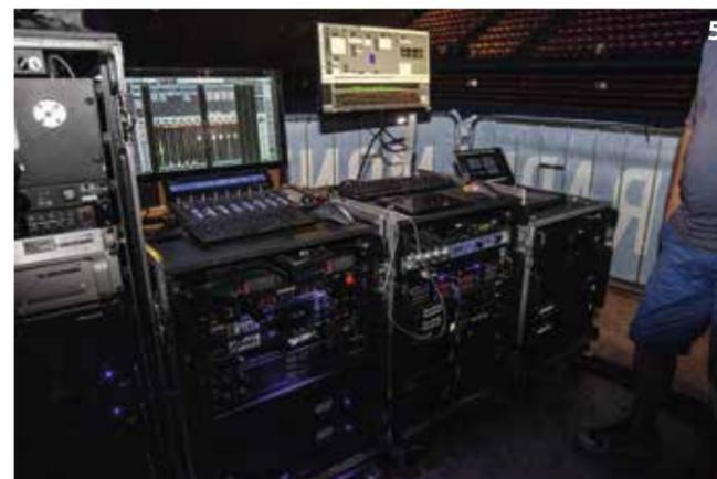
5\_ La postazione al FoH con il mixer di produzione LV1 Waves a sinistra e i drive rack dell'impianto a destra.
